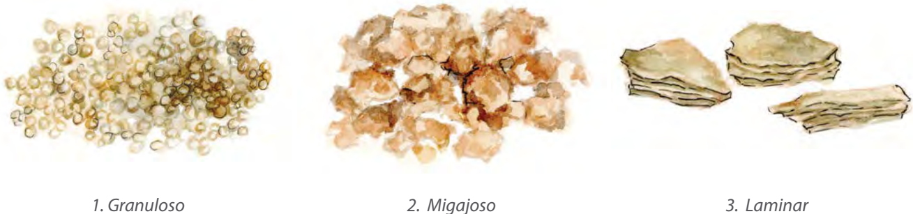
Figura 3-10: Estructura del suelo de izquierda a derecha (1) granular, (2) migajoso, (3) laminar
