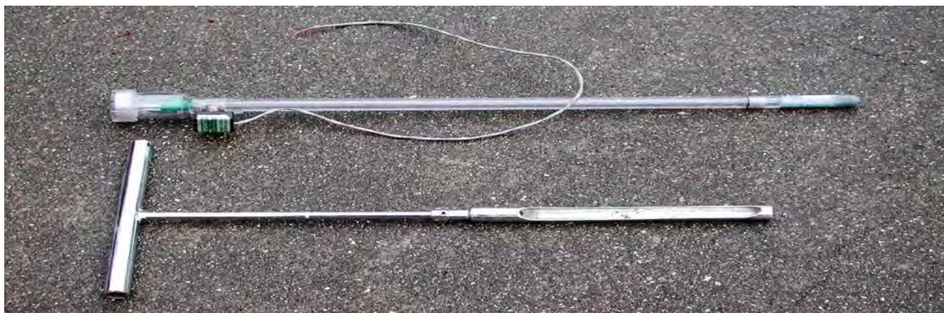
Figura 3-17: Tensiómetro arriba, sonda de suelo abajo
